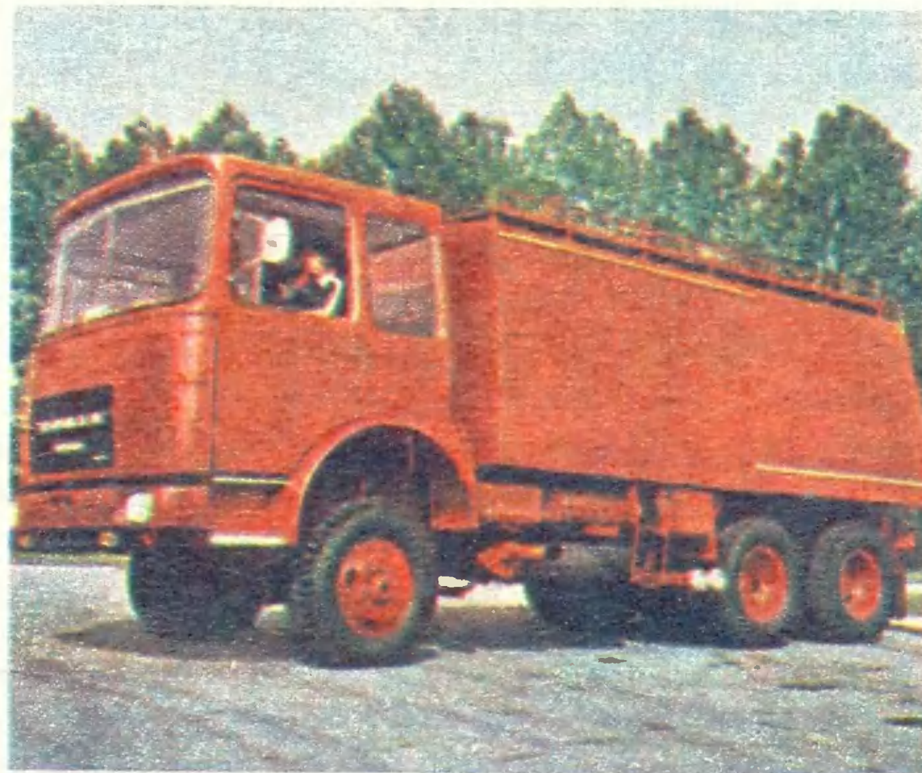
Цистерна АПКАА-12.215. Полная масса — 18 500 кг; длина — 8615 мм; ширина — 2500 мм; высота — 3100 мм.
